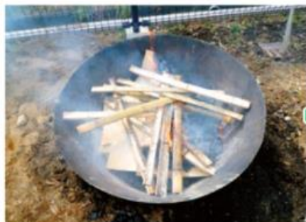
①M100 を使用し竹炭を作ります。 ボール紙と竹を入れて着火します。 炎が全体に行き渡るまで煙が出ます。
